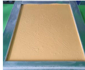
6단계 : 콘크리트 용액을 패널 제작틀에 투입
